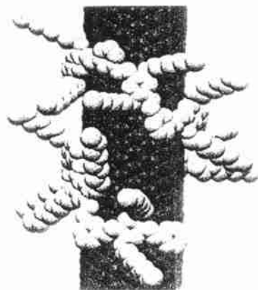
图 3 PmPV/SWNT 复合材料结构示意图 [41]
